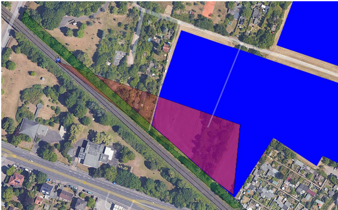
Abbildung 21: Von potenzieller Blendung betroffener Sichtbereich der Bahntrasse Fahrtrichtung Süd, PV-Fläche in Blau, betroffener Sichtbereich des Fahrers in Rot und bestehende Sichtunterbrechung in Grün
