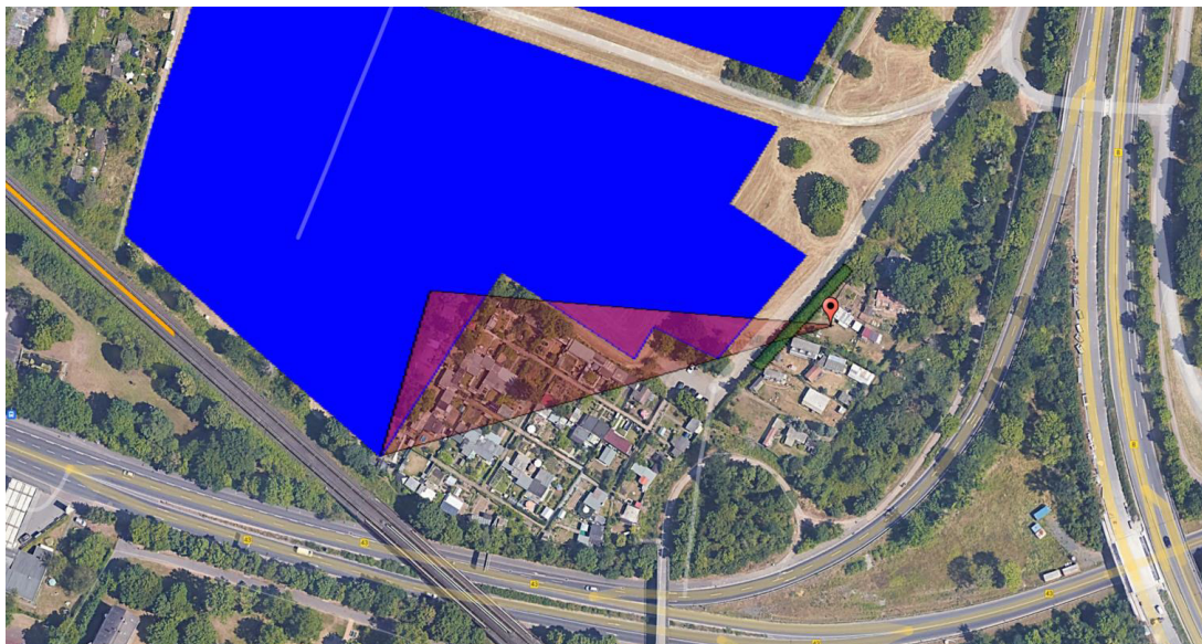
Abbildung 15: Von potenzieller Blendung betroffene Kleingartenanlage, PV-Fläche in Blau, betroffener Sichtbereich in Rot
